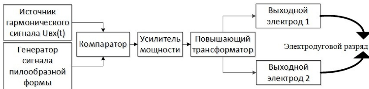
Рис. 1. Структурная схема звуковоспроизводящего устройства
